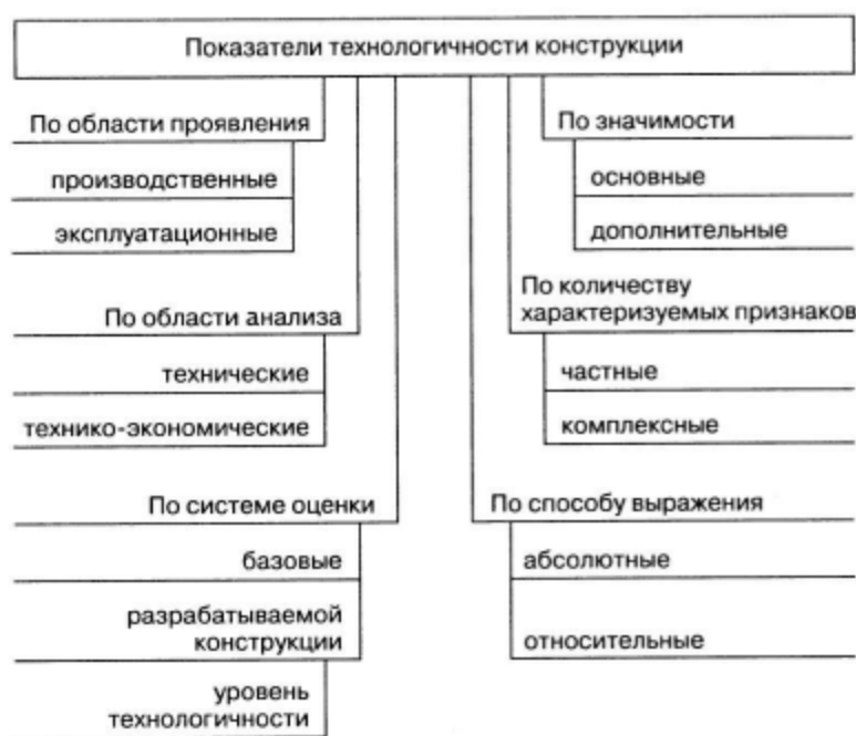
Рис. 3.3. Классификация показателей технологичности конструкции изделий
