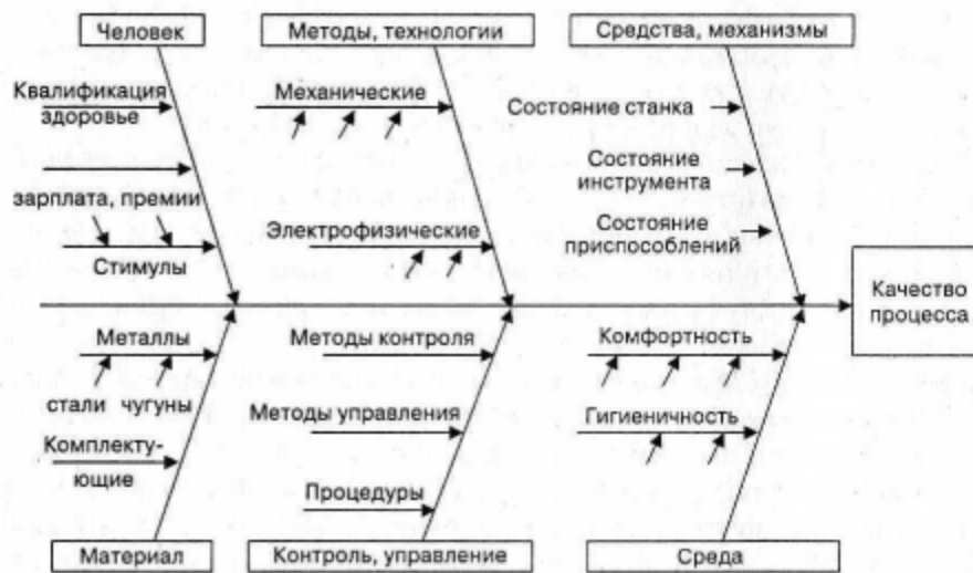
Рис. 6.2. Причинно-следственная диаграмма технологического процесса
