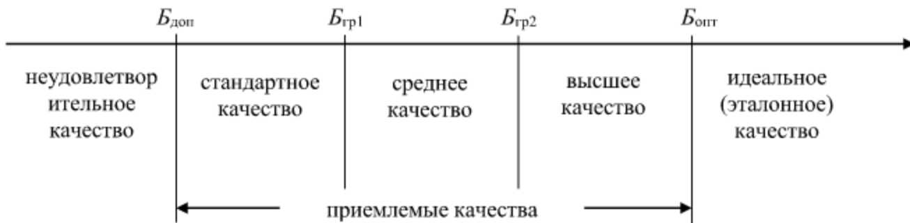
Рис. 3.7. Квалиметрическая интервальная шкала реальных и приемлемых качеств продукции и процессов
