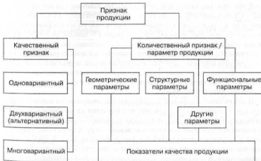
Рис. 3.1. Схема взаимосвязи понятий признака, параметра и показателя качества продукции
