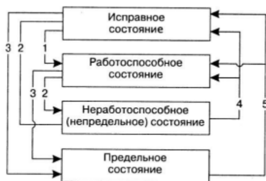
Рис. 3.2. Схема основных состояний и событий объекта:
